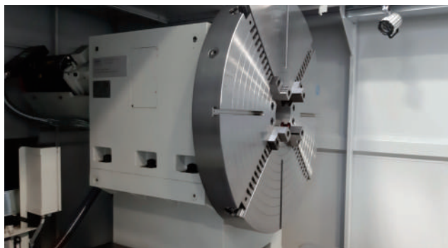
Piattaforma manuale con quattro griffe indipendenti Manual chuck with four independent jaws
