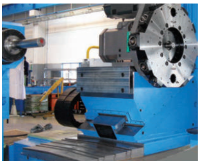
Torretta asse orizzontale su asse Y inclinato Horizontal axle turret equipped with Y axis
