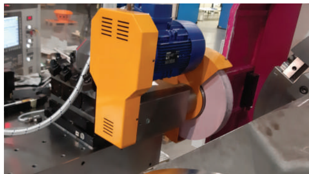
Gruppo rettifica da esterni su torretta quadra Grinding unit installed on square turret side
