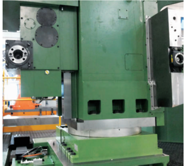
Montante di fresatura e tonitura Column with milling & turning units
