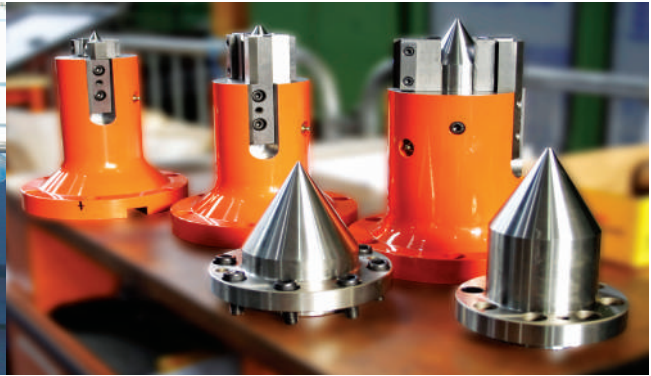
Esempio di mole a tazza comune per le BM 48'' - 64'' Example of grinding cup for BM 48'' - 64''
